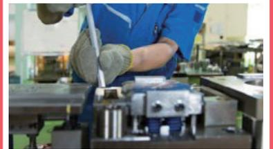
金属の板を部品の形に整えるための金型を作ります。難しい形にもチャレンジして作り上げます。
